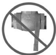
A.) Inkorrekte Installation: Heizband hängt frei von der Oberfläche
